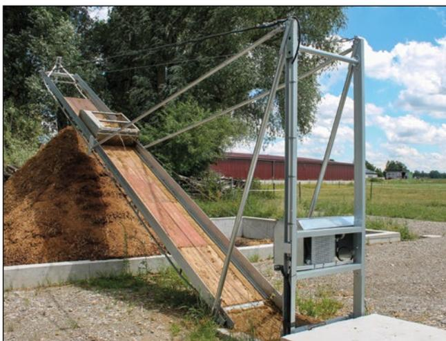
Abwurframpe mit Unterflurschieber und Antriebswinde
